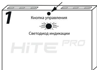
Нажмите и удерживайте Кнопку управления на блоке радиореле в течение 1-ой секунды. Нажатие Кнопки управления осуществляйте неметаллическим предметом.
